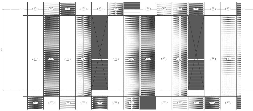
PARTIAL ELEVATION AT TYPICAL PODIUM SCREEN WALL
