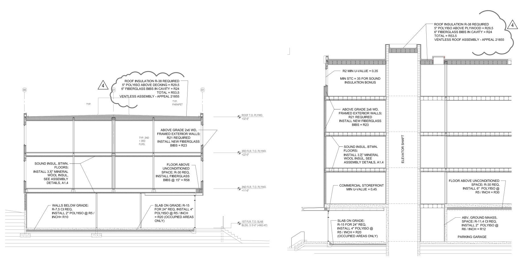
**INSULATION NOTES:** - ROLL-IN BATT INSULATION IS TO BE AVOIDED WHENEVER AND WHEREVER POSSIBLE
